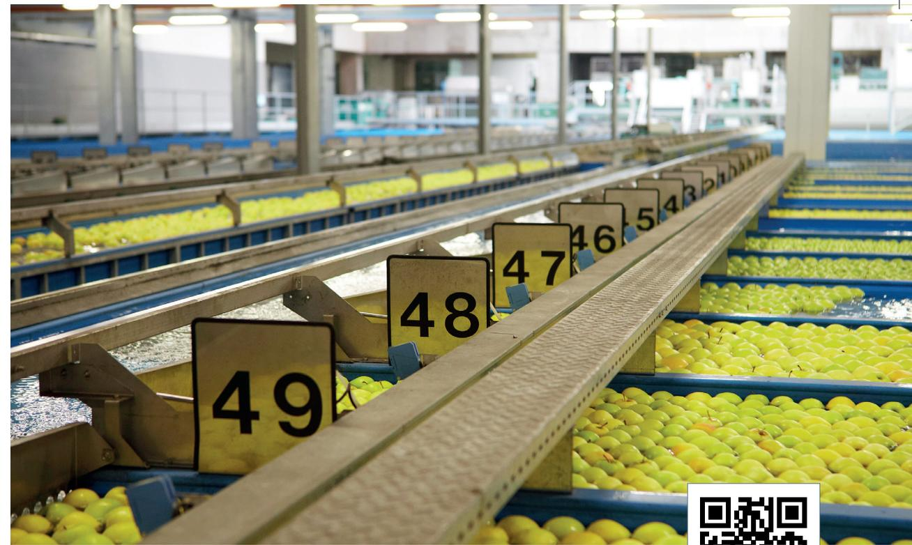
Nach der Entnahme aus der Kühlzelle werden die Äpfel nach Größe, Farbe, Schalenreinheit und Schadstellen sortiert. Vor der Verpackung werden sie mit Trinkwasser gewaschen und gebürstet.
